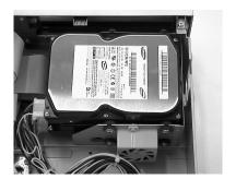
7. HDDブラケットが製品の内側にしっかりと取り付けられていることを確認した後、電源ケーブル、 信号通信ケーブル (DEケーブル)、ファンケーブルをHDDに接続します。
